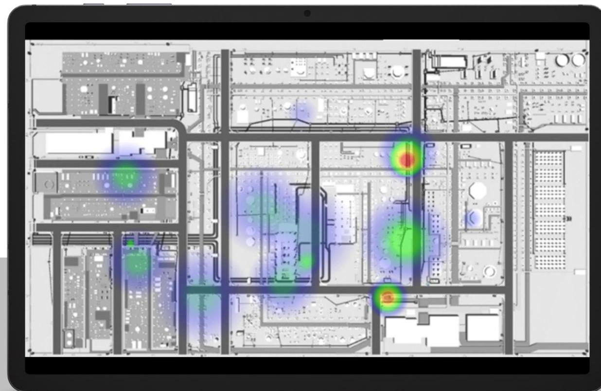
施工性検討時に工事中に起こり得るハザードを検知し、事前に設計に織り込むことで工事遅延の未然防止が可能。
